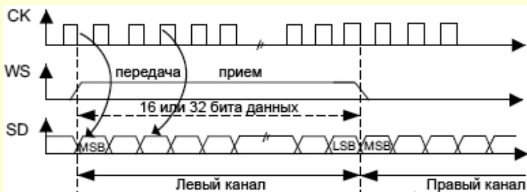
Рис. 270. MSB justified 16 или 32 бита, длина полной точности, CPOL=0.
