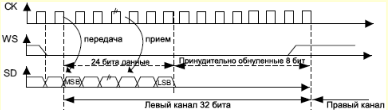
Рис. 265. Диаграммы протокола I2S Philips, 24-битный фрейм, CPOL=0.
