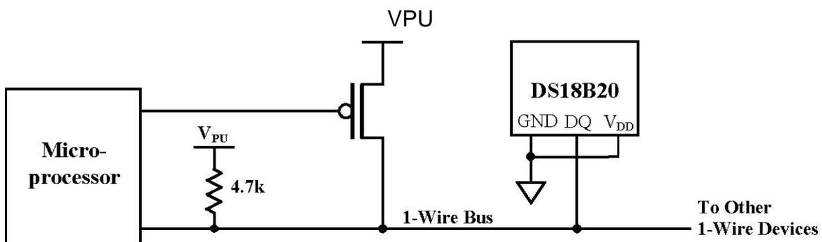
**Подключение DS18B20 в режиме внешнего питания рис 5.**
