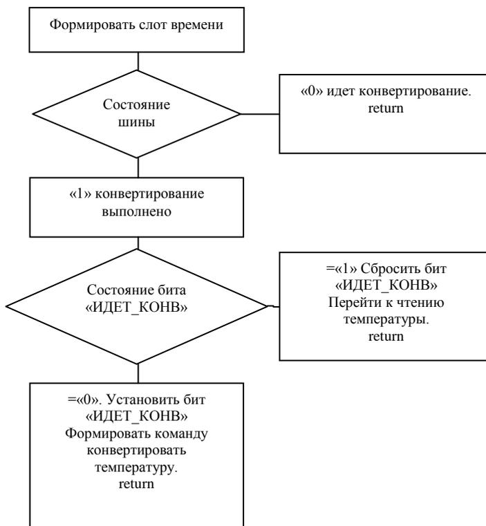
Пример программы для PIC16 (для работы с одним устройством на линии)
